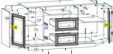
С помощью эксцентриков (поз.50) и шкантов (поз.60) соедините стенки вертикальные поз.9,10 со стенкой горизонтальной поз.8, и плинтусом поз.13, соединив сначала одну сторону, затем другую. Вверните в крышку поз.7 дюбеля (поз.51), затем утсановите данную стенку с помощью эксцентриков (поз.50).
