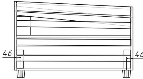
Закрепите опоры на подлокотник при помощи шурупов 3,8x64 с отступами по 46 мм от фронтальной и тыльной сторон и отступом 35 мм от внутренней стороны.
