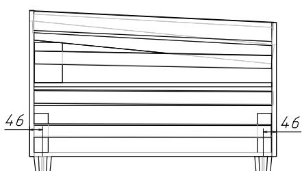
Закрепите опоры на подлокотник при помощи шурупов 3,8x64 с отступами по 46 мм от фронтальной и тыльной сторон и отступом 35 мм от внутренней стороны.
