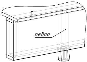
Закрепите Опоры мебельные А263 Н=50 спереди короба при помощи шурупов 3,5x41, при этом крепить следует на три шурупа (см.вид сверху), 4-й шуруп не вкручивается. Два шурупа вкручиваются в торец боковины короба, один - в брус.
